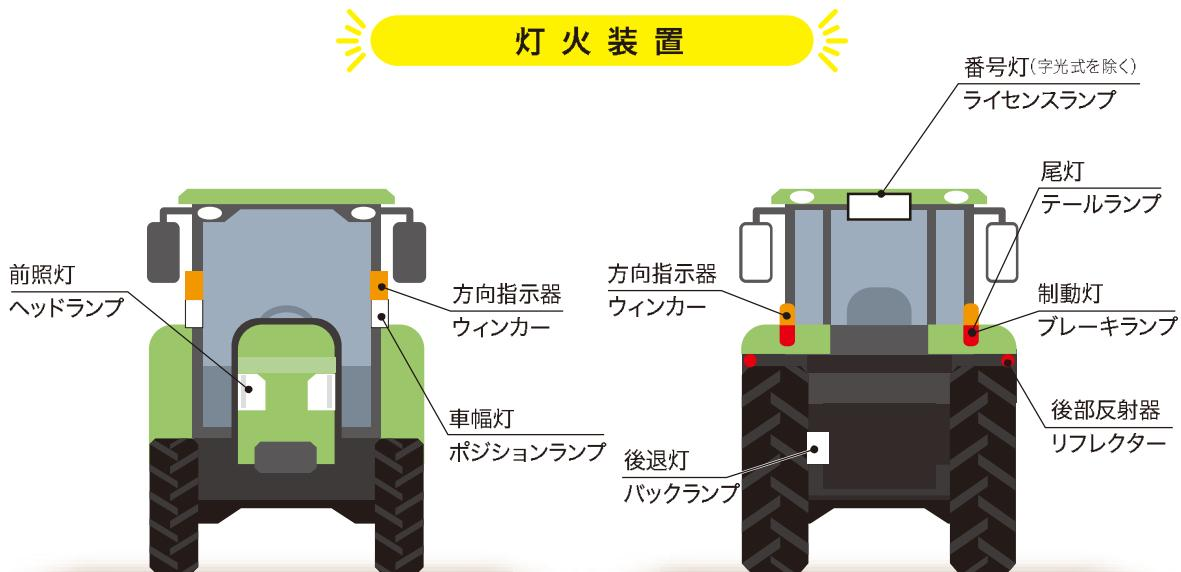
灯火装置、反射器の位置はトラクタのメーカー、シリーズ、型式により異なります。
