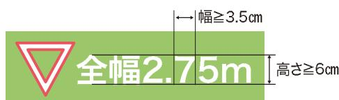
※緩和の表示は後方から見やすい位置であれば原則トラクタ・作業機どちらに表示しても構わないが、作業機ごとに幅や緩和の対象が変わるため、トラクタ単体に関わるものはトラクタ本体に、作業機に関わるものは作業機側に表示することが望ましい。
