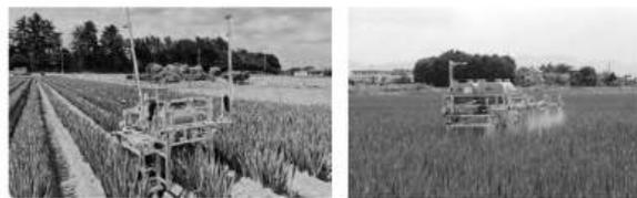
ねぎの自動農薬散布ロボット
