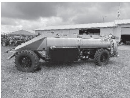
GUSS 社の自動走行スピード・スプレーヤー
